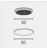
La grille nid d'abeille est un accessoire utilisé pour l'effet anti-reflets. Réduit le flux lumineux de 20%.
