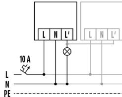
Installation standard avec raccordement en parallèle de 8 appareils au maximum..
